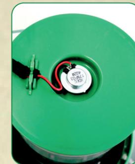
Sistema elettronico per la riproduzione del **segnale vibrazionale** emesso dalle femmine per l'attrazione del maschio.
