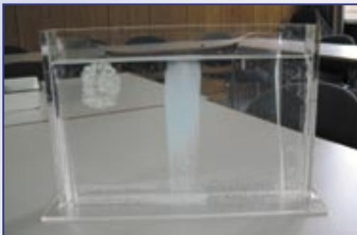
Confronto della resistenza al dilavamento di Patrol rispetto ad un Idrossido di rame 15% DF. Test effettuato applicando i due prodotti su una lastra di vetro, lasciata asciugare ed immersa in acqua per simulare una pioggia battente.
